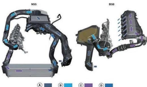
图 9 宝马 N55、B58 发动机进气系统结构
