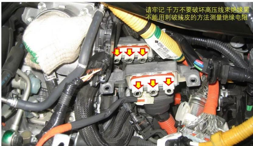
切记，测量绝缘电阻不要破坏橙色绝缘层，不能用刺破线皮的方法测量绝缘电阻。按照上图所示，断开连接器，从连接器端子测量绝缘电阻。
