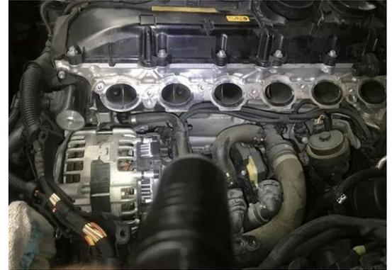
图 6 用核桃砂清洗后的进气门
