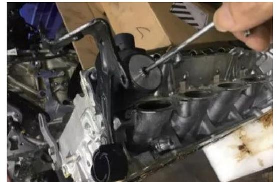
图 7 将内六角螺栓顺时针拧到底
