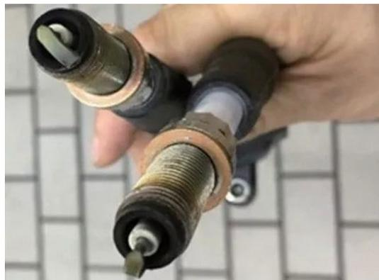
图 3 故障车火花塞颜色偏黑
